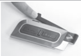
Выдвижная антенна для расширения диапазона связи
